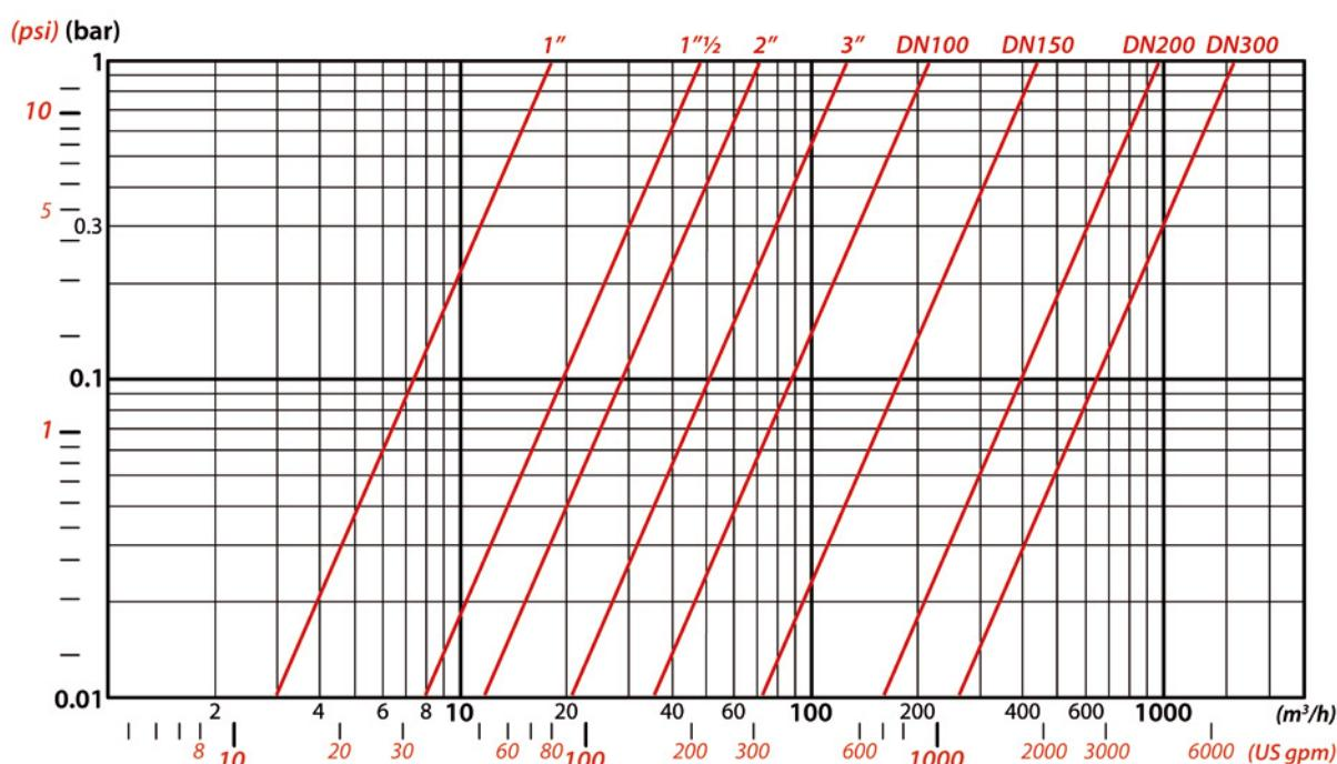
Perdite di carico riferite a filtri con rete filtrante da 120 µm e acqua pulita - Head losses are referred to filters with 120 µm filtering mesh and clean water.
