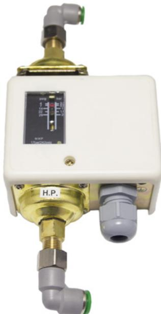
I filtri **SIMPLEX** possono essere dotati di Kit per il controllo della differenza di pressione tra ingresso ed uscita. Questo optional permette di collegare il filtro ad un allarme che si attiva quando il  $\Delta P$  raggiunge il valore preimpostato, in modo che un operatore sia avvisato quando eseguire la pulizia del filtro.
