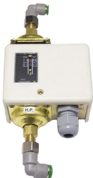
I filtri **BASKET** possono essere corredati di Kit per il controllo della differenza di pressione tra ingresso ed uscita. Questo optional permette di collegare il filtro ad un allarme che si attiva quando il  $\Delta P$  raggiunge il valore preimpostato, in modo che un operatore sia avvisato quando eseguire la pulizia del filtro.
